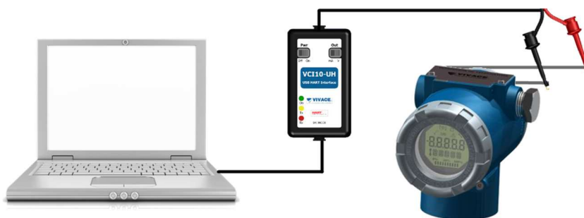
Figura 3.6 - Esquema de ligação da interface VCI10-UH alimentando o VTT10-FH.
