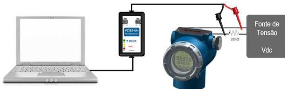
Figura 3.5 - Esquema de ligação da interface VCI10-UH ao VTT10-FH com alimentação externa
